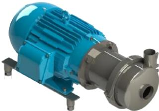
O modelo BX possui adaptador prolongado que acomoda o selo e mantém a bomba distanciada do motor, prezando a sanitariiedade do equipamento além de estar adequado as normas de segurança NR10. Com exceção do motor todas as partes são construídas em aço inox 304 sanitário, sendo que as que tem contato com o líquido bombeado podem ser em 304, 316 ou 316L. O motor possui grau de proteção IP 55 e recebe acabamento de pintura epóxi com proteção à corrosão.
