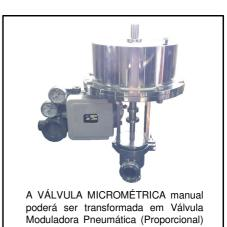
A VALVULA MICROMETRICA manual poderá ser transformada em Válvula Moduladora Pneumática (Proporcional) montando-a com atuador Pneumático e posicionador eletropneumático (IP). Solicite catálogo específico.
